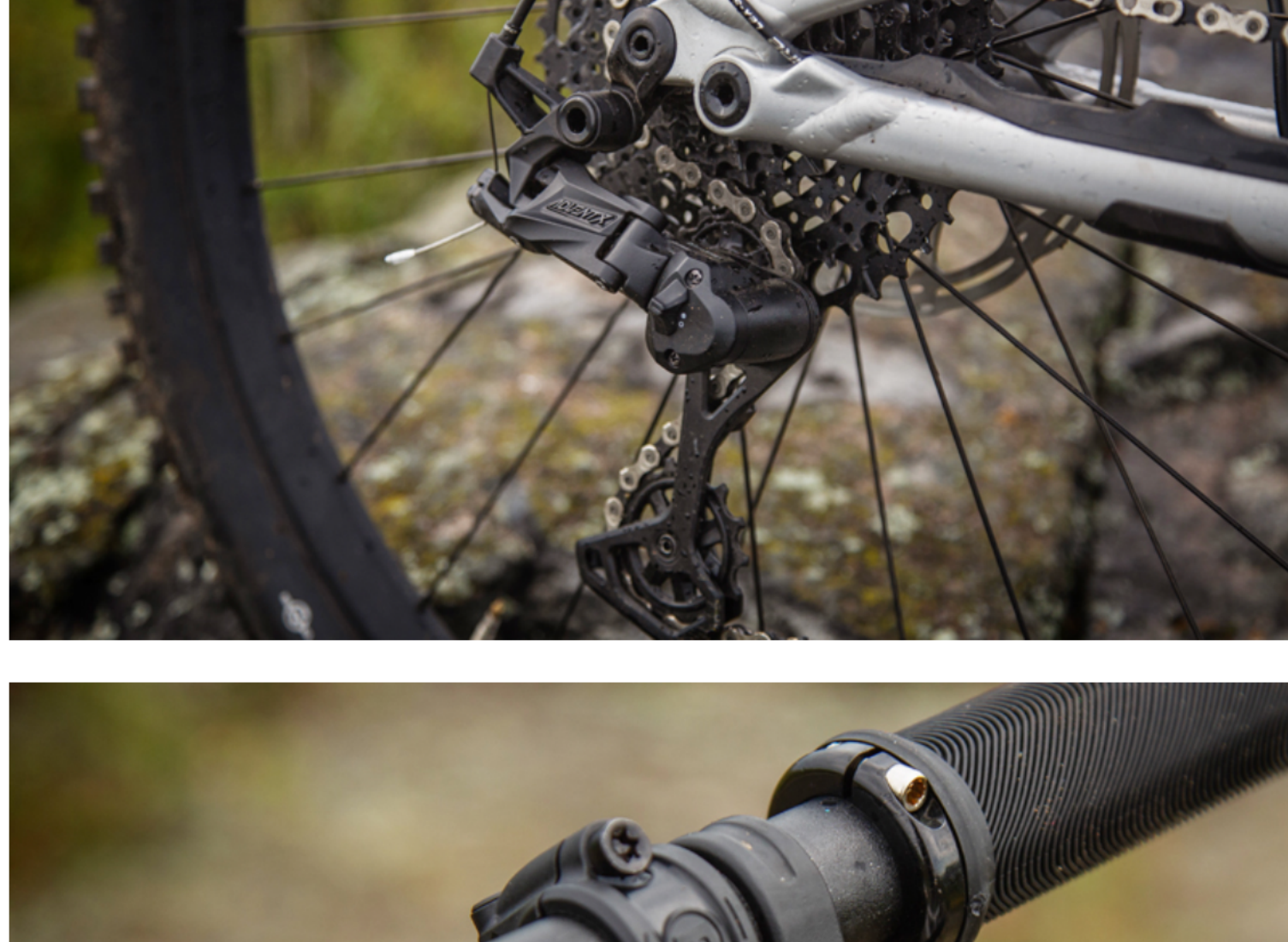
Dérailleur arrière ADVENT X chape moyenne et shifter Trail Trigger Pro.
